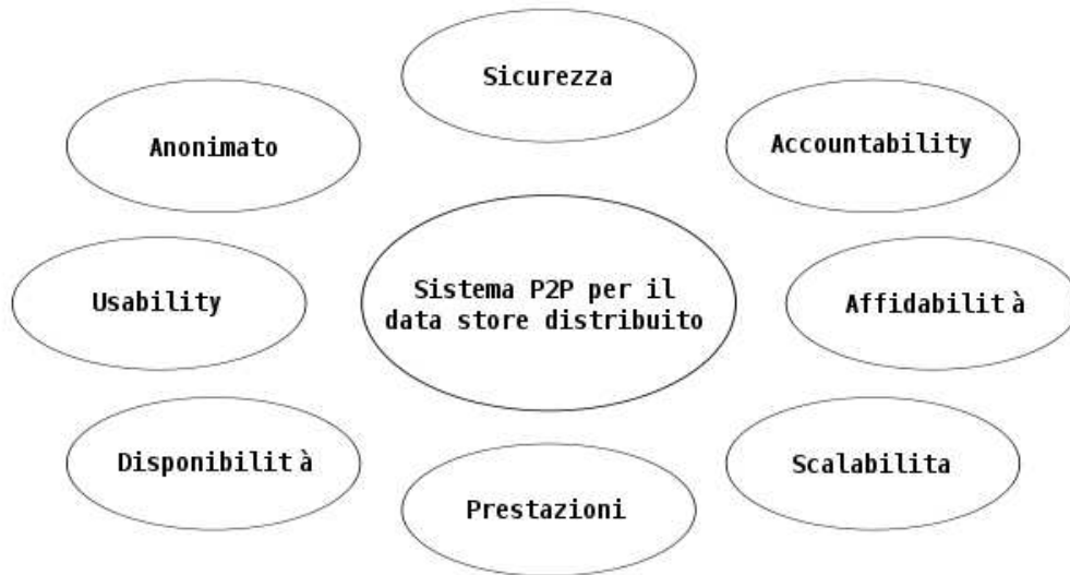
Figura 6.7: Proprietà concorrenti in un sistema P2P per il data store distribuito.
